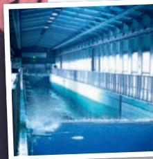
Sturmfluten und Monsterwellen im Labor – das simuliert und erforscht u. a. das Forschungszentrum Küste (FZK) im Großen Wellenkanal (GWK). Seit 1996 ist das FZK führend bei der Untersuchung maritimer Strukturen und neuer Entwicklungen im Küstenschutz. Mit etwa 300 m Länge, 5 m Breite, 7 m Tiefe und Wellenhöhen bis zu über 3 m ist der GWK eine der größten Versuchseinrichtungen ihrer Art weltweit. Zusätzliche Infos unter: [www.fzk.uni-hannover.de](http://www.fzk.uni-hannover.de)
